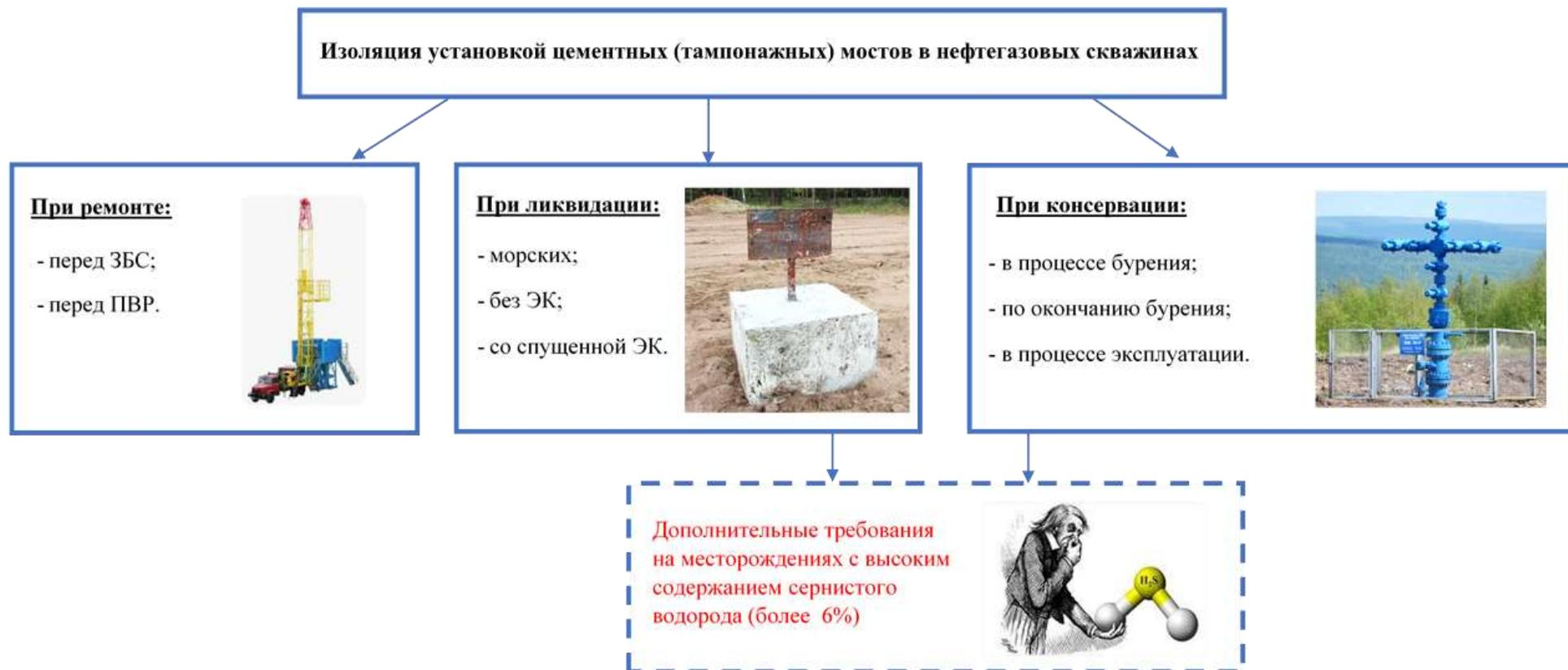
Рисунок 2 – Случаи установок цементных (тампонажных) мостов в нефтегазовых скважинах
