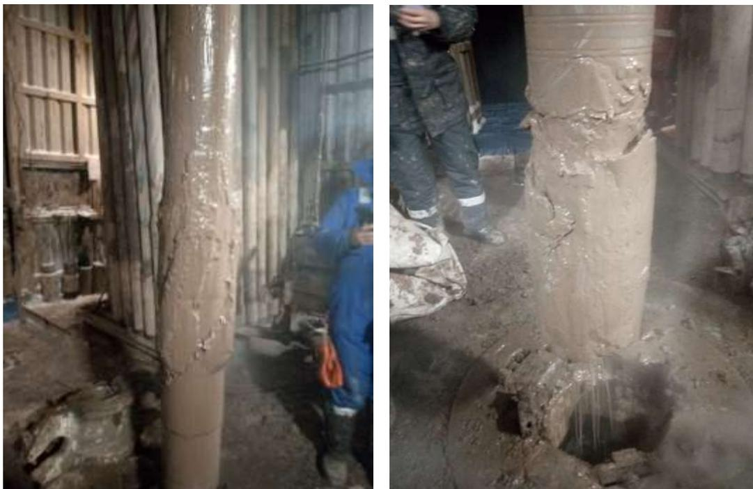
Рисунок 1 – Сальник на калибрующем элементе КНБК и породоразрушающем инструменте
