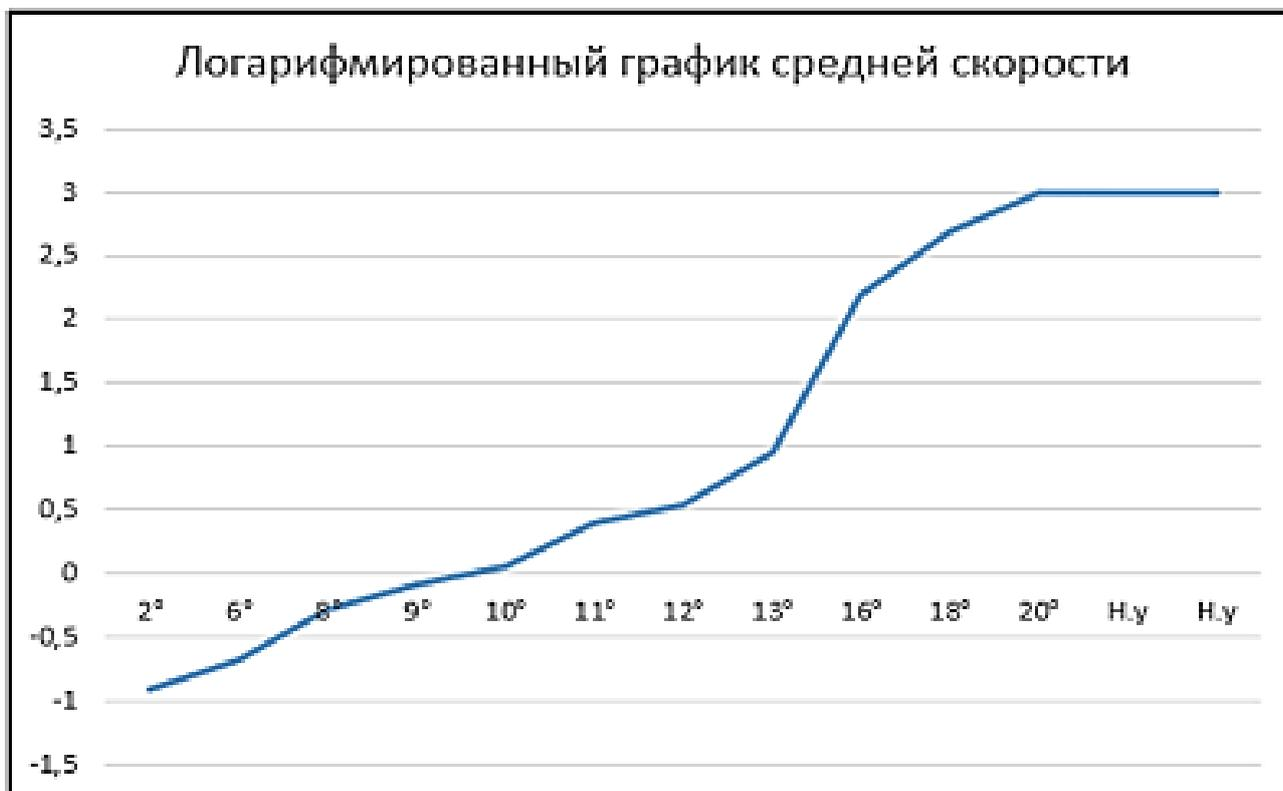
Рисунок 5 –График логарифма средней скорости распространения фронта давления в зависимости от температуры
