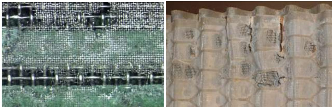
Рисунок 2 – Абразивный износ
