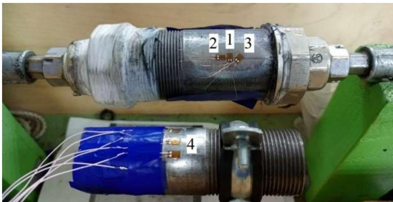
Тензодатчики для измерения деформаций: 1 – кольцевой; 2 – продольной; 3 – под углом 45 градусов к оси трубы; 4 – термокомпенсирующие тензодатчики
