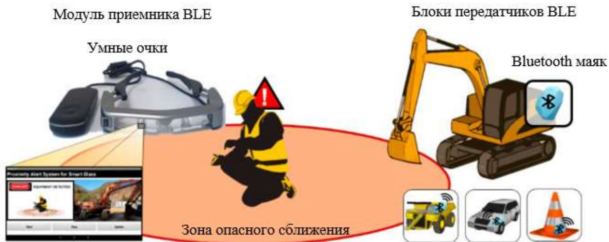
Рисунок 2 - Общий вид концептуальной персональной системы предупреждения об опасном приближении, включающей блок приемника Bluetooth с низкой энергией и блоки передатчиков BLE [3]
