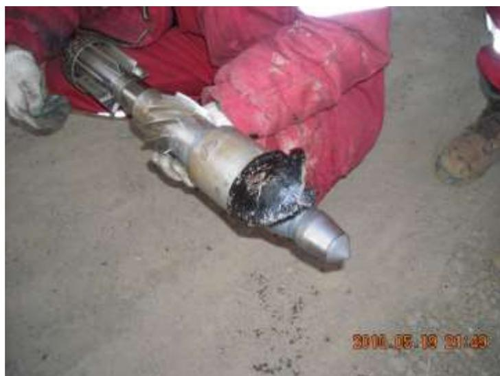
Рисунок 3 – Заклинка оборудования вследствие попадания резинового элемента
