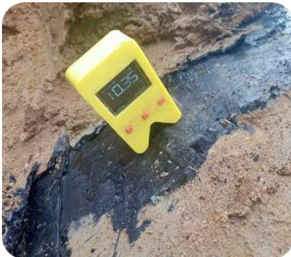
Рисунок 3 – Носимый прибор-индикатор в рабочем положении на трубе
