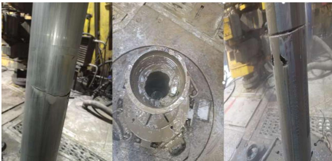
Рисунок 1 – Последствия износа бурильных труб
