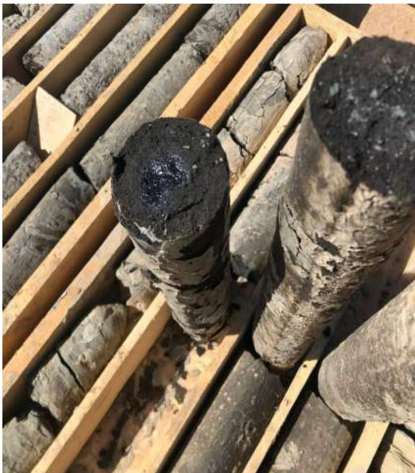
Рисунок 1 - Фото характерного нефтенасыщенного ядра месторождения Янги Узбекистан (450м)
