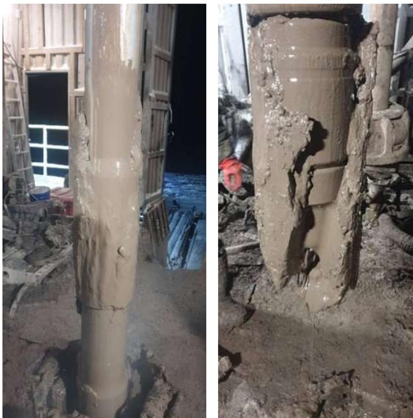
Рисунок 2 – Сальник на калибрующем элементе КНБК и породоразрушающем инструменте
