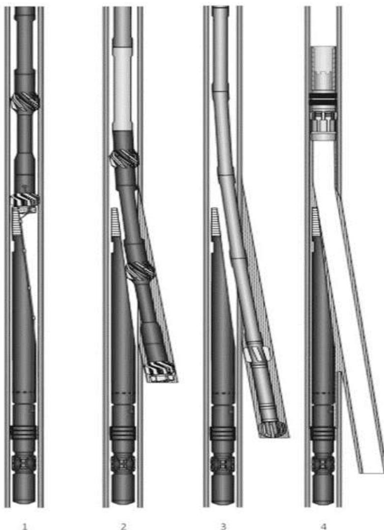
1, резка окна 2, бурение в боковой стволе 3, установка хвостовика через окно 4
