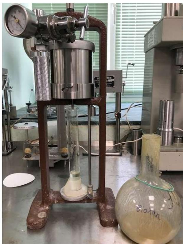
Рисунок 3 – Оценка фильтрации бурового раствора, содержащего биополимер, после прогрева до 95<sup>0</sup> С
