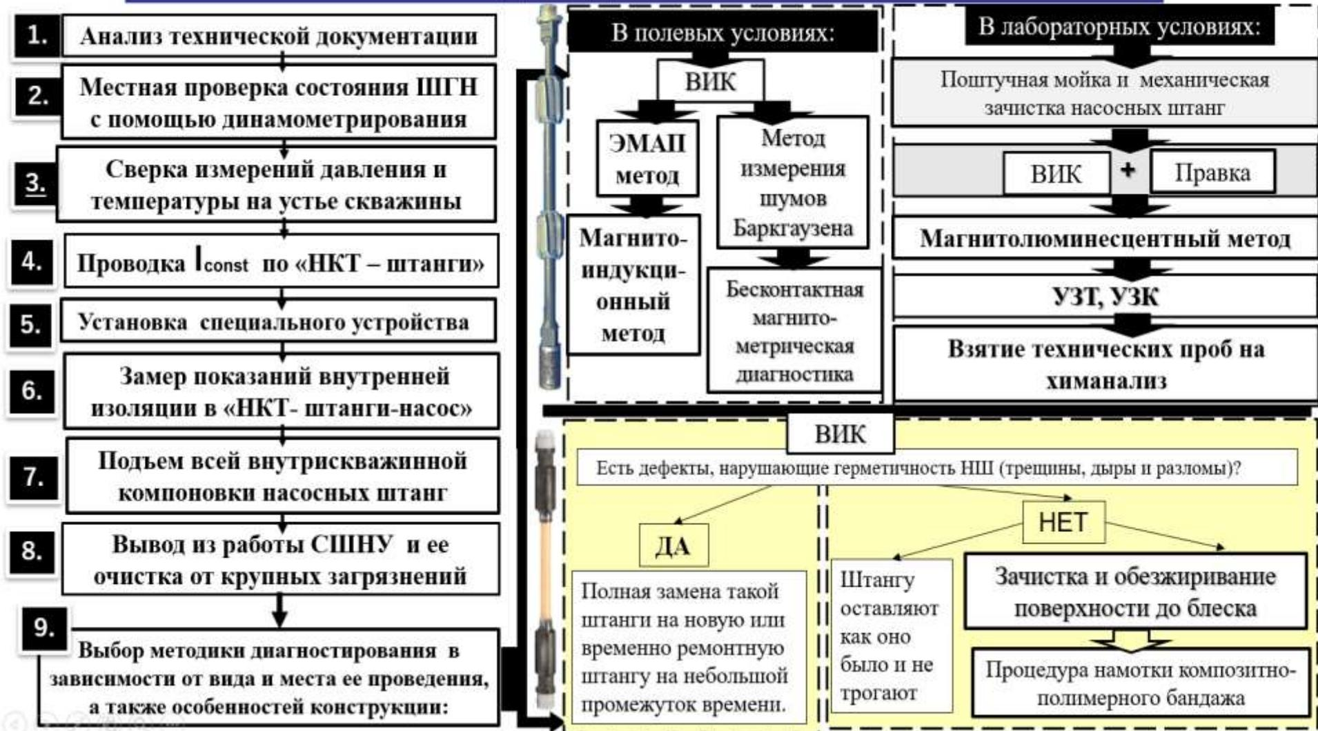
Рисунок 4 – Последовательность проведения современной методики диагностики насосных штанг
