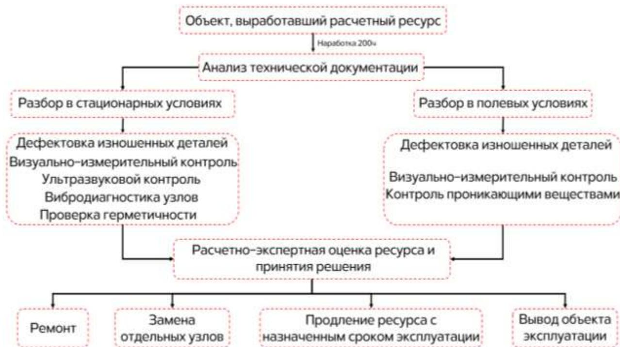
Рисунок 3 – Блок-схема методики
