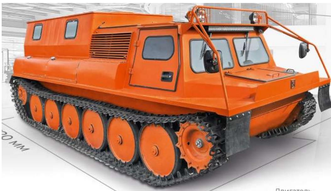
Рисунок 1 – Пример стандартного гусеничного вездехода
