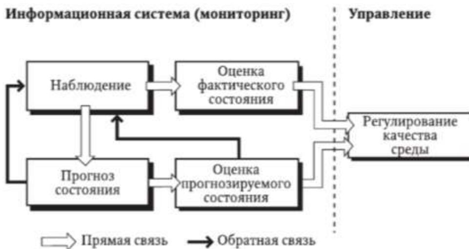
Рисунок 1 - Блок-схема системы мониторинга
