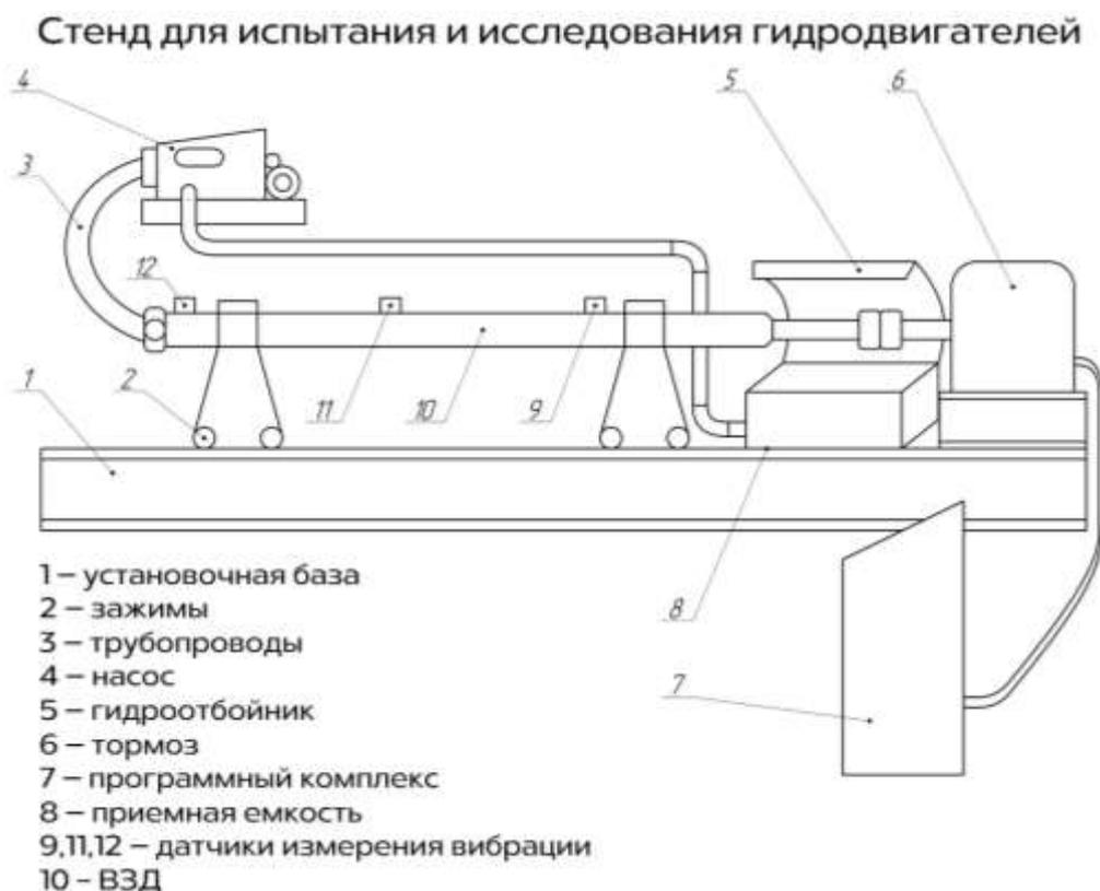
Рисунок 2 – Стенд для испытаний ВЗД
