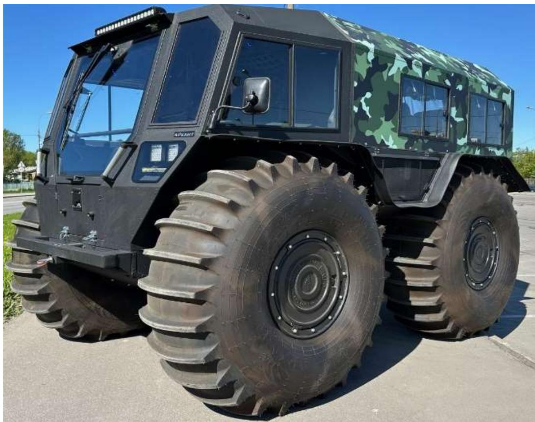
Рисунок 2 – Бортоповоротный вездеход «Архант N»
