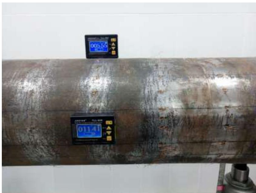
Рисунок 2 – Два инклинометра, установленные на верхнюю и боковую образующие трубы
