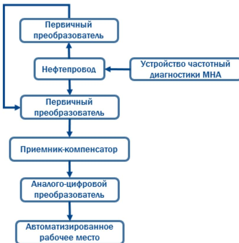
Рисунок 3 – Предлагаемая схема методики диагностирования агрегата от УГТУ
