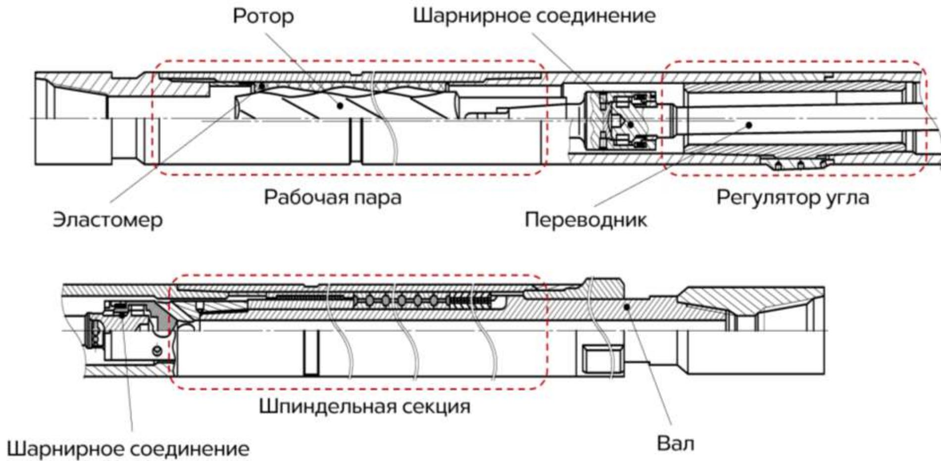
Рисунок 1 - Конструкция ВЗД
