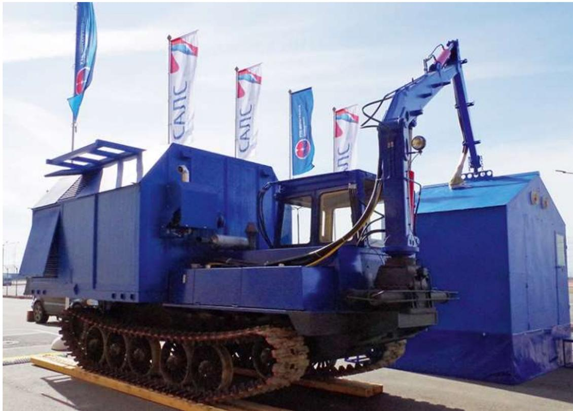
Рисунок 4 – Самоходное шасси с краном-манипулятором
