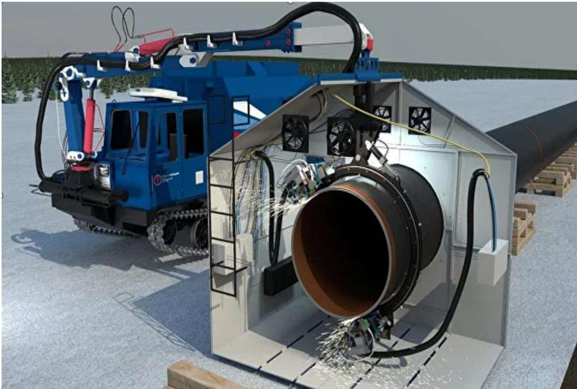
Рисунок 1 – Самоходный агрегат лазерной сварки
