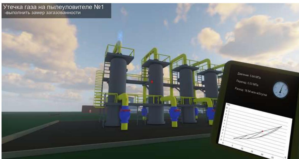
Рисунок 1 – Прототип VR-симулятора «Утечка природного газа из циклонного пылеуловителя узла очистки газа»
