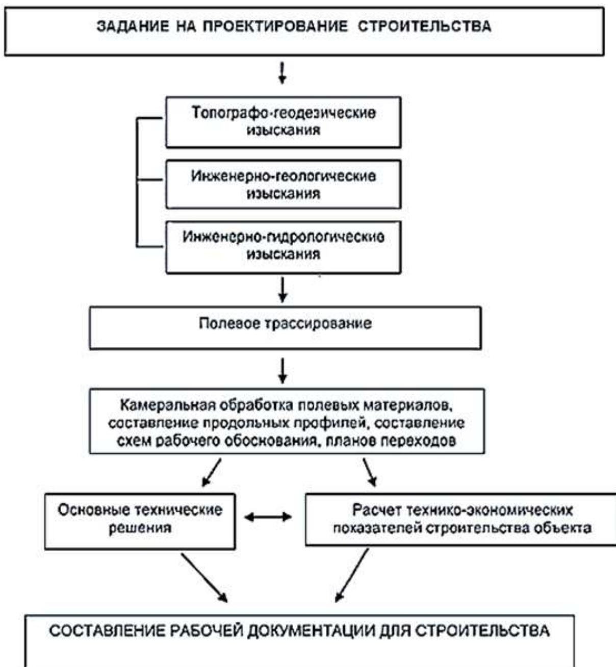
Рисунок 2 – Технологическая схема выполнения геодезических работ для разработки проекта строительства
