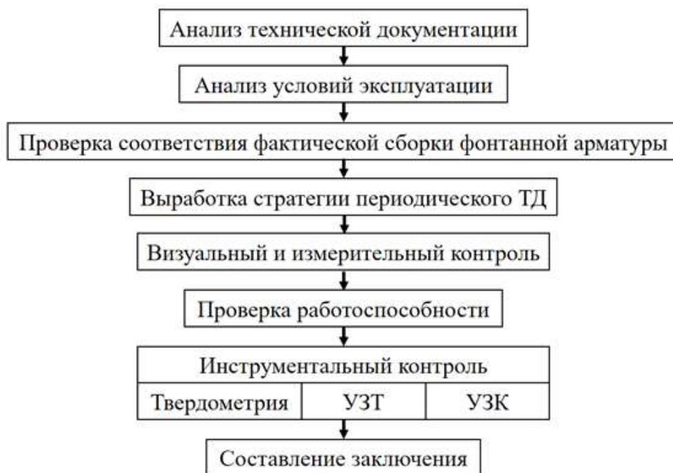
Рисунок 3 – Методика диагностирования в соответствии с СТО Газпром 2-2.3-139-2007
